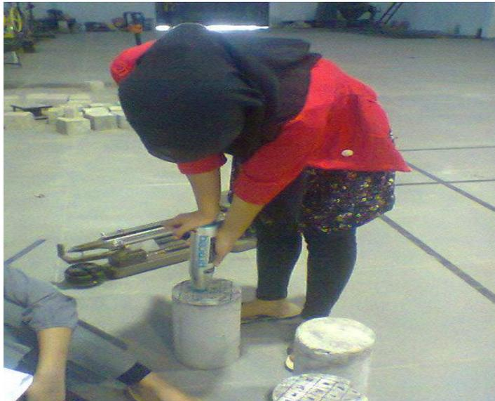
Gambar 2. Pengujian Nilai Kuat Pantul Beton
