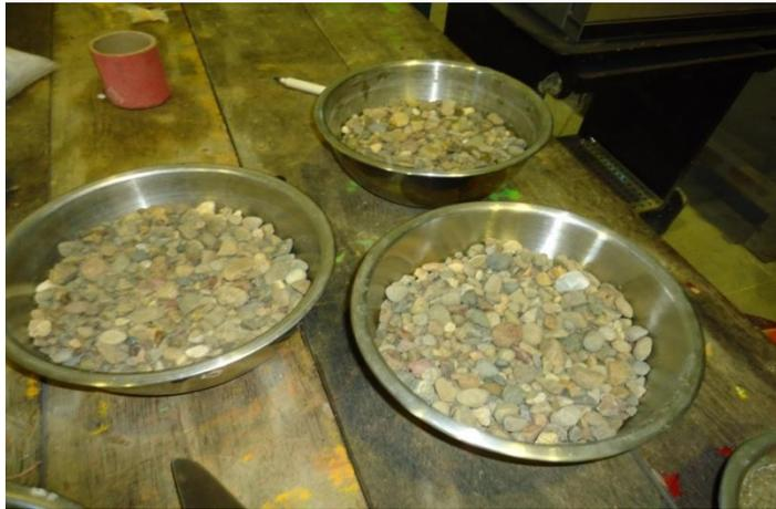
Gambar 1. Pengujian Berat Jenis Agregat Kasar
