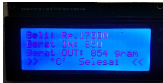
Gambar 15 Pengujian Penimbangan dengan Masukan Harga
