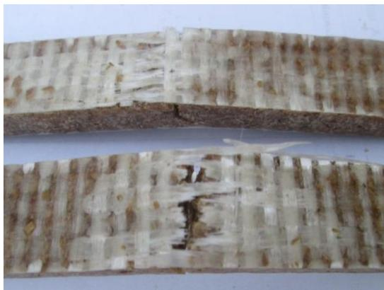
Gambar 6. Pola Patahan Modus Gabungan Pada Spesimen Yang Diperkuat Serat Gelas Roving.
