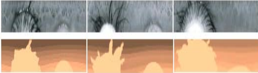
Gambar 1.5 Normalisasi pola iris (baris atas) dan Normalisasi peta kualitas terkait (baris bawah). Normalisasi tersebut menunjukkan distorsi tidak linier bila pusat iris dan pupil tidak bertepatan
