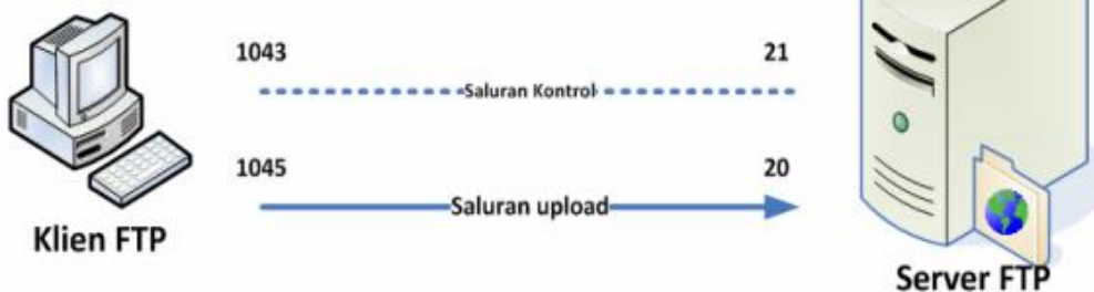
Gambar 5. Cara kerja FTP Server
