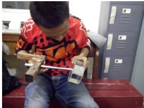
Gambar 4.14 Pemasangan Poros Ke Dudukan Sudu
