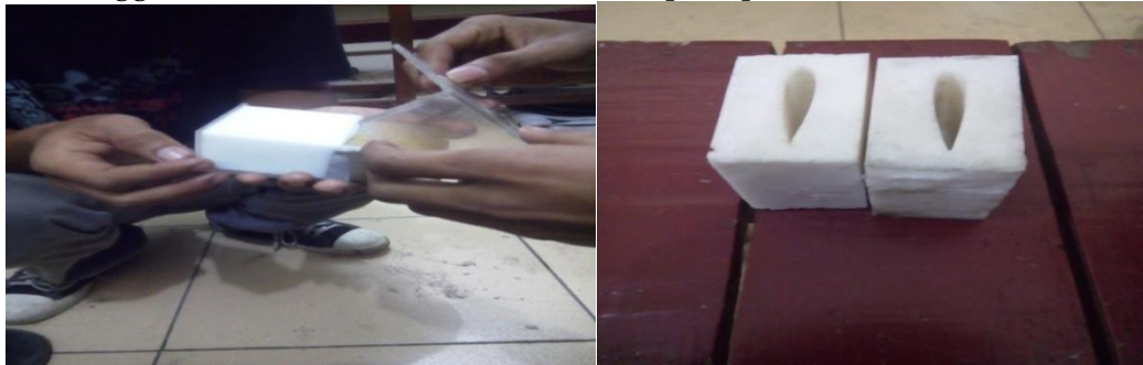
Gambar 4.4 Proses pembongkaran cetakan
