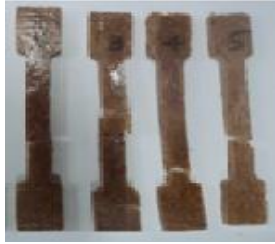
Gambar 3. Specimen bahan komposit PF setelah uji statis.
