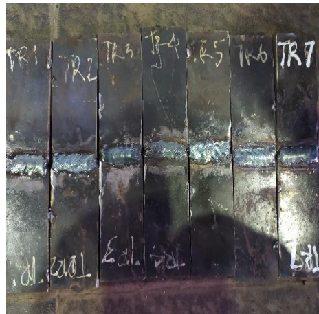
Gambar 2. Hasil pengelasan dengan elektroda terekspos
