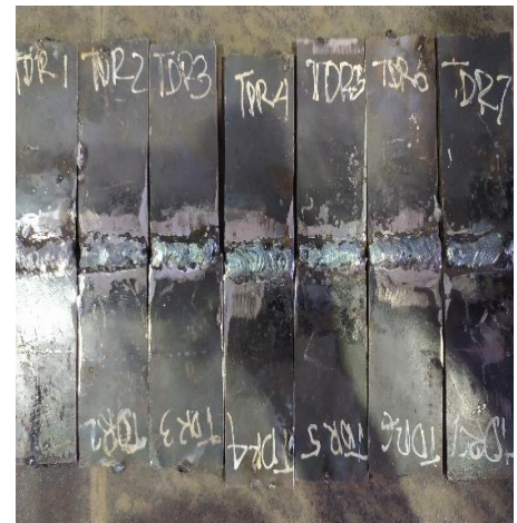
Gambar 3 Hasil pengelasan dengan elektroda tidak terekspos
