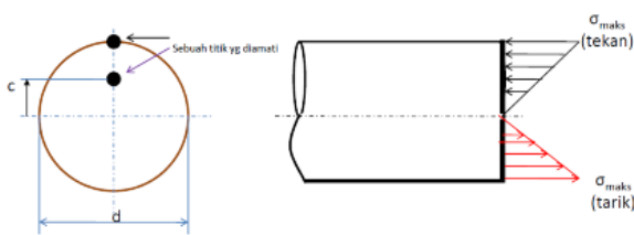
Gambar 5. Distribusi tegangan normal pada poros
