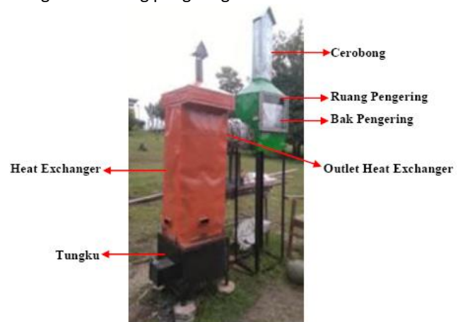
Gambar. 1 Kontruksi alat pengering mekanis tipe bak
