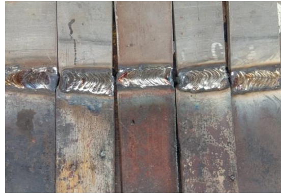
Gambar 2. Hasil pengelasan las SMAW dengan variasi kuat arus
