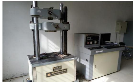
Gambar 8 Alat uji tarik (Tensile test)
