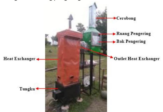
Gambar. 1 Kontruksi alat pengering mekanis tipe bak
