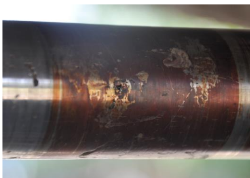
Gambar 1. Korosi Sumuran material SS AISI-304 pada poros baling-baling kapal
