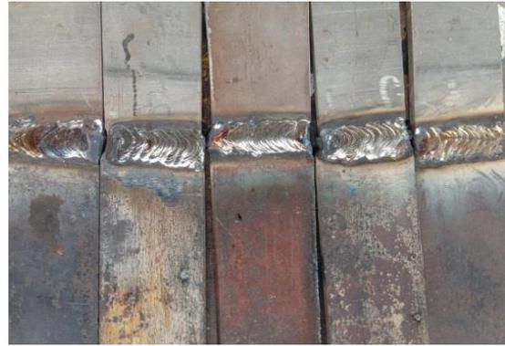
Gambar 2. Hasil pengelasan las SMAW dengan variasi kuat arus
