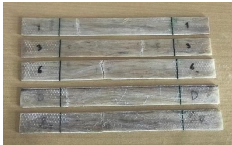
Gambar 6. Spesimen 85% : 15% Setelah Uji Tarik
