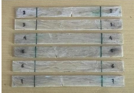
Gambar 4. Spesimen 60% : 40% Setelah Uji Tarik
