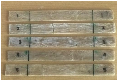
Gambar 5. Spesimen 70% : 30% Setelah Uji Tarik
