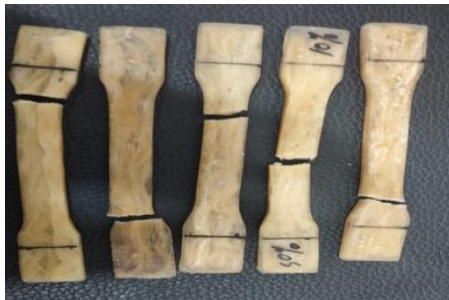
Gambar 4. Hasil Pengujian Tarik
