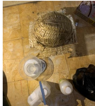
Gambar 11. Pelapisan Resin Pada Anyaman Safety Helmet
