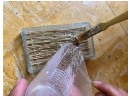
Gambar 7. Penuangan Resin Di Atas Anyaman Serat Bamboo
