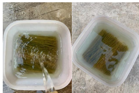
Gambar 3. Perendaman menggunakan larutan NaOH
