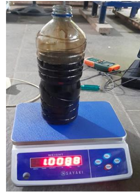
Gambar 6 Proses Penimbangan bahan bakar oli bekas
