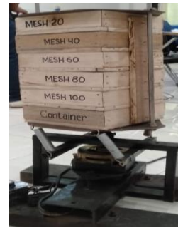
Gambar 2. mesin Ro-Tab lengkap dengan ayakan Pengujian dilakukan sebanyak 5 kali pengulangan, hasil pengujian dapat dilihat pada Tabel 3.
