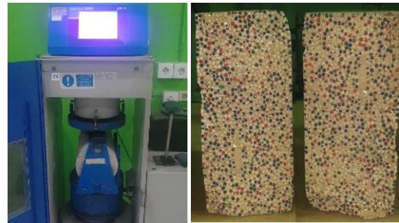
Gambar 4. Setup pengujian kuat tarik belah dan belahan sampel BP100
