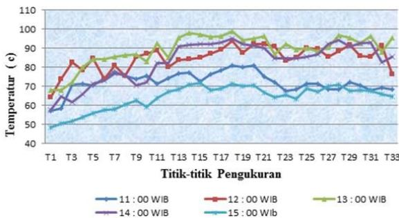
Gambar 6. Distribusi temperatur absorber pada laluan kolektor surya dengan dua belokan memanjng 180°
