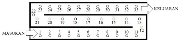
Gambar 5. Posisi pengukur temperatur kolektor dua belokan memanjng 180°
