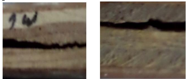
Gambar 8. Pola kegagalan Specimen yang di inisiasi oleh delaminasi pada bagian lapisan core.
