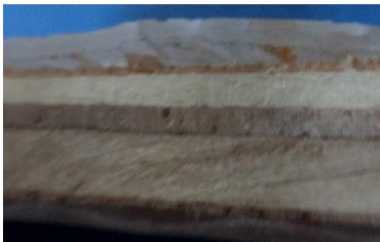
Gambar 10. Permukaan patahan spesimen yang dibuat dari bahan plywood (core) yang dihaluskan
