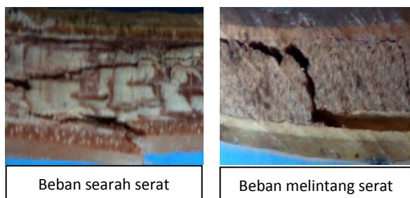
Gambar 4. Penampang patahan spesimen yang dibebani searah serat plywood dan melintang arah serat plywood.
