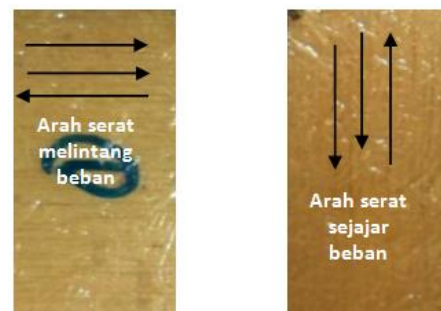
Gambar 2. Plywood yang dipotong tegak lurus arah serat dan sejajar arah serat
