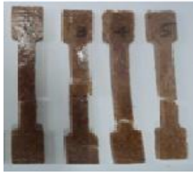
Gambar 3. Specimen bahan komposit PF setelah uji statis.
