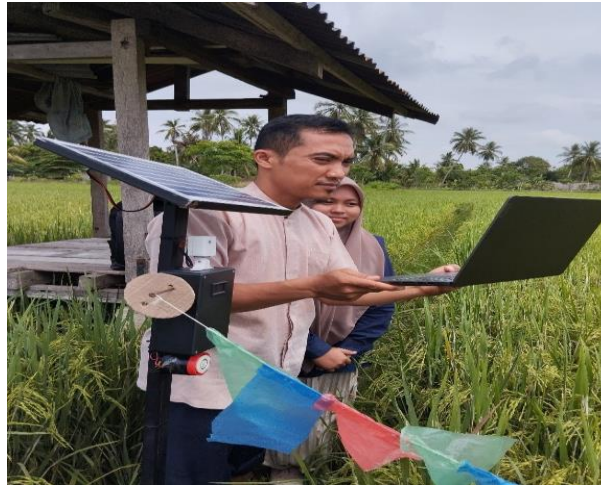
Gambar 2. Internet of Thing dalam Sistem Monitoring Hama Burung
