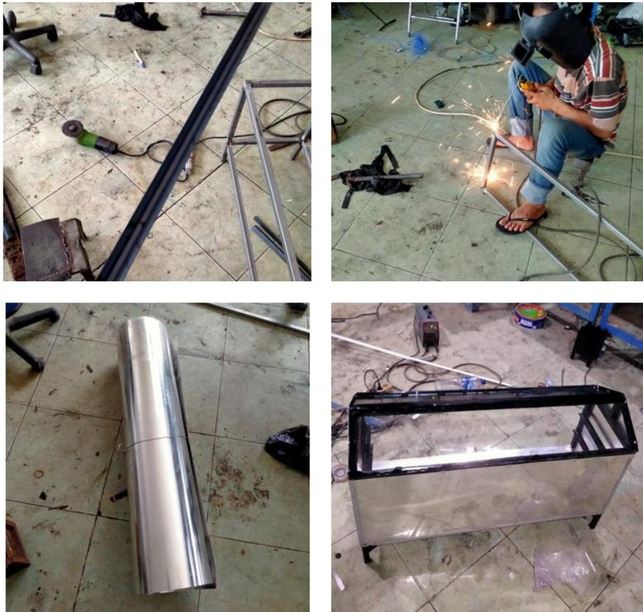
Gambar 2. Proses pembuatan alat pengering pisang sale
