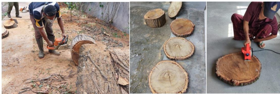
Gambar 1 Proses persiapan bahan baku berupa pangkal batang kayu mahoni
