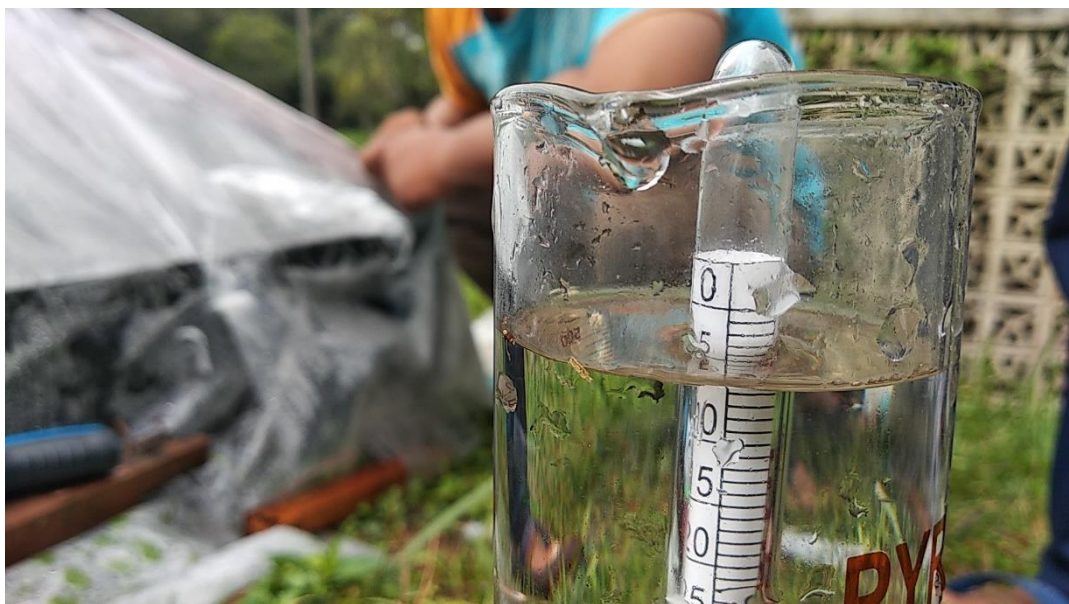
Gambar 9. Pengukuran kadar garam, dengan menggunakan Hydrometer Baume.
