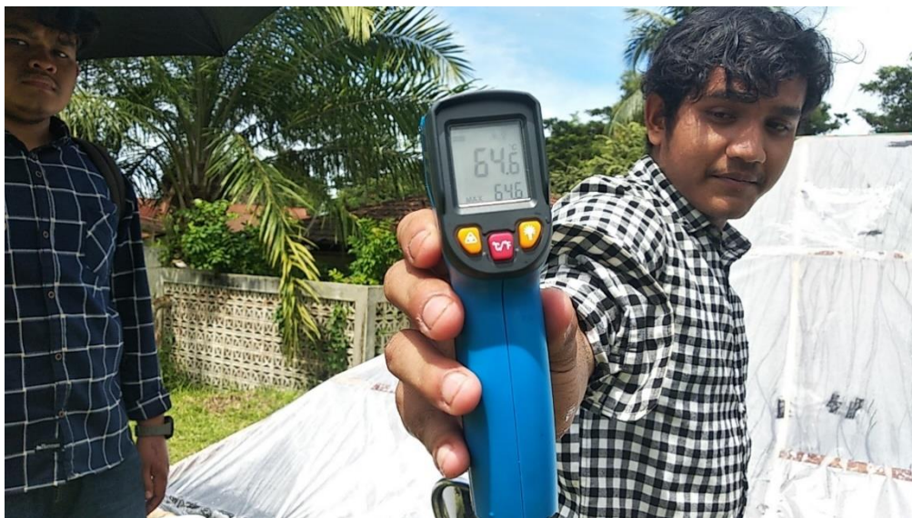
Gambar 7. Pengukuran temperatur udara menggunakan Infrared di dalam dan di luar kolam atap prisma.
