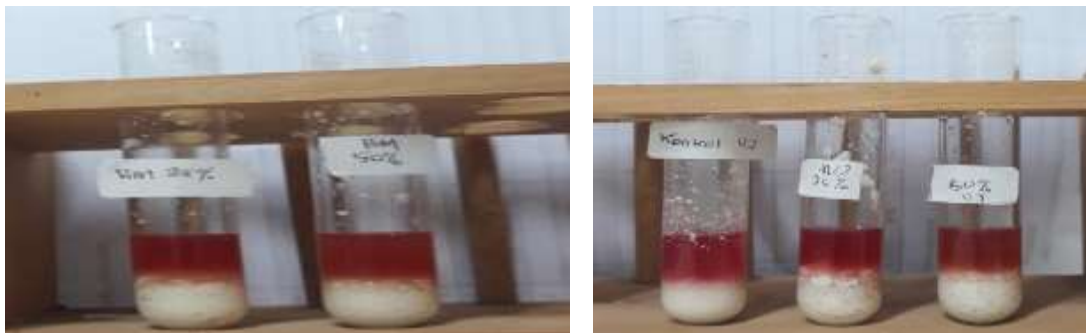
Gambar 4. Deteksi formalin pada sampel tahu putih dengan perlakuan formalin (dari kiri ke kanan BM;UJ)
