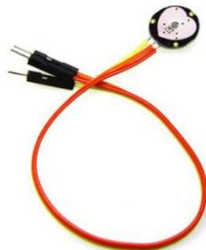
Gambar 2.3 Sensor Detak Jantung
