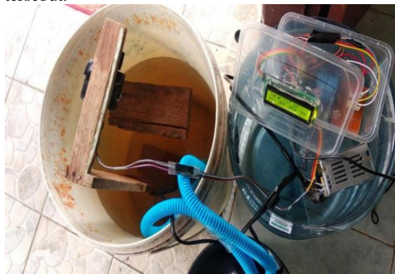
Gambar 3.8. Pengujian Sensor Ultrasonic HC-SR04 Terhadap Sampah Kayu
