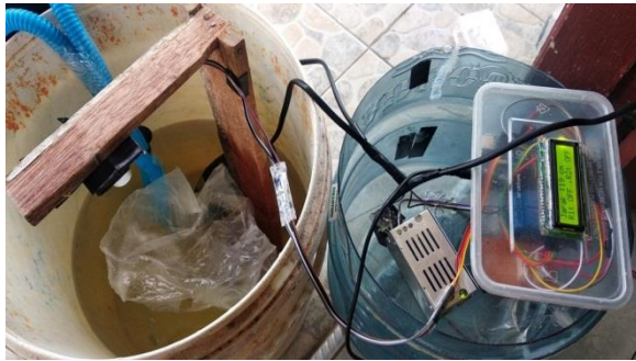
Gambar 3.7 Pengujian Sensor Ultrasonic HC-SR04 Terhadap Sampah Pelastik
