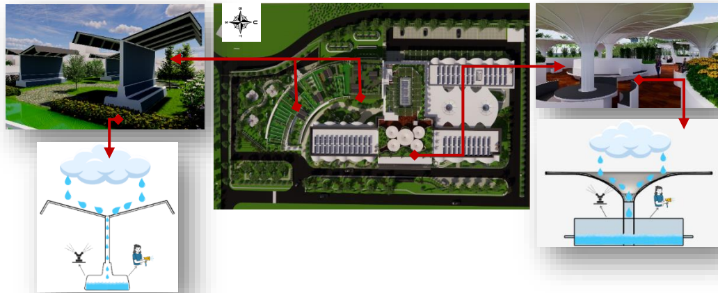
Gambar 14. Sistem Pengairan pada Green Roof .
