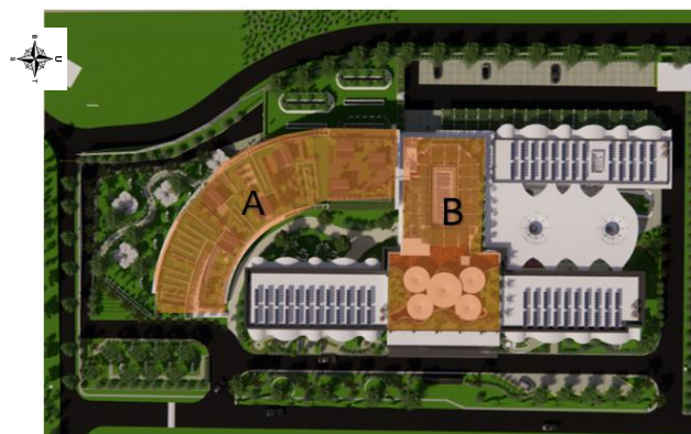
Gambar 10. Perletakan 2 Zona green roof di Fakultas Teknik
