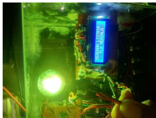
Gambar 3.3. Pengujian Sensor LDR pada saat PLN menyala
