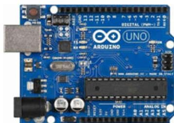
Gambar 2.6 Arduino UNO ATmega 328[12].
