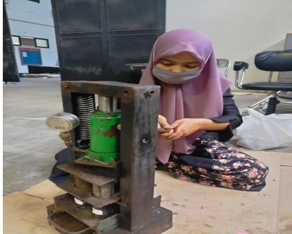
Gambar 1. Pencetakan Biopellet
