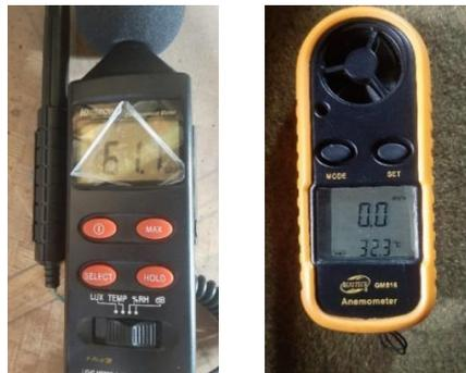
Gambar 5. Alat pengukuran *Environment Meter krisbow KW06-291 4* dan Anemometer
